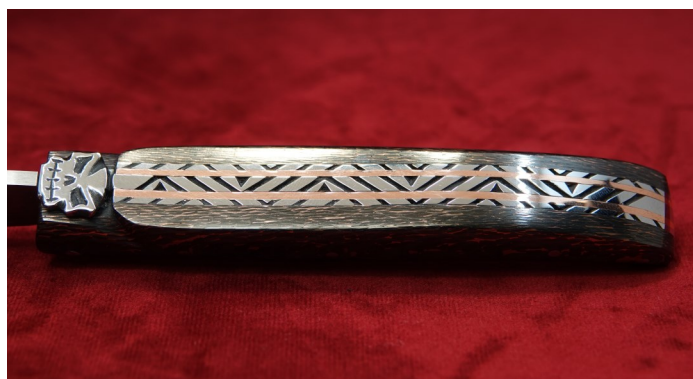
Simple platines guillochées et intercalaires cuivre
